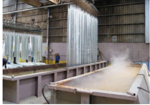
الشطف المعاكس للتيار يمكن استعماله عادة في عمليات التصفيح الكهربائي
