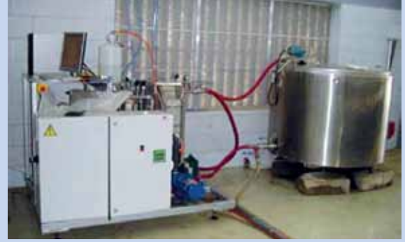
الشكل ب2 عملية التدفق في وحدة التقطير بالأغشية
